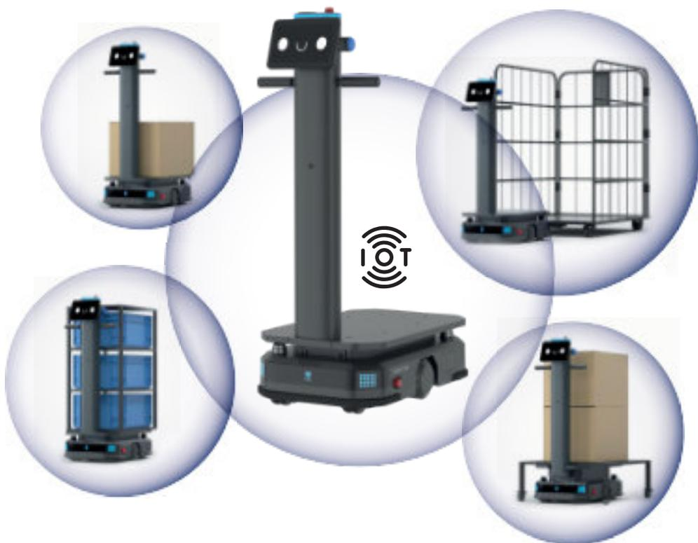
Robot de transporte con un robusto chasis muy resistente con arquitectura abierta que permite múltiples personalizaciones. Incluye una pantalla táctil de 10,1" para un fácil uso por parte del usuario. Equipado con capacidades esenciales de IOT como control de ascensores, navegación puerta a puerta y funcionalidad de localización remota. Mapeo de superficies de hasta 200.000 m<sup>2</sup> y carga hasta 300 Kg.
