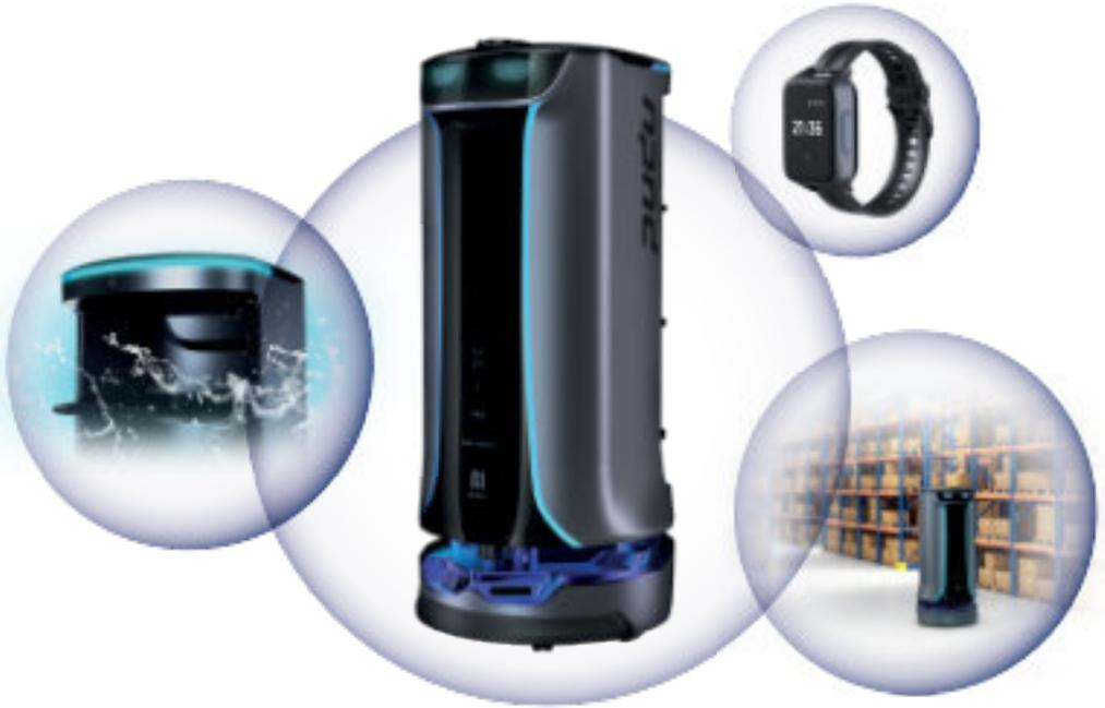
Robot de transporte equipado con alta capacidad de carga de hasta 60 kg. Función de localización y reconocimiento de gestos.
